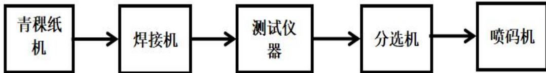
图 2-7 派克电池工艺设备连接示意图
