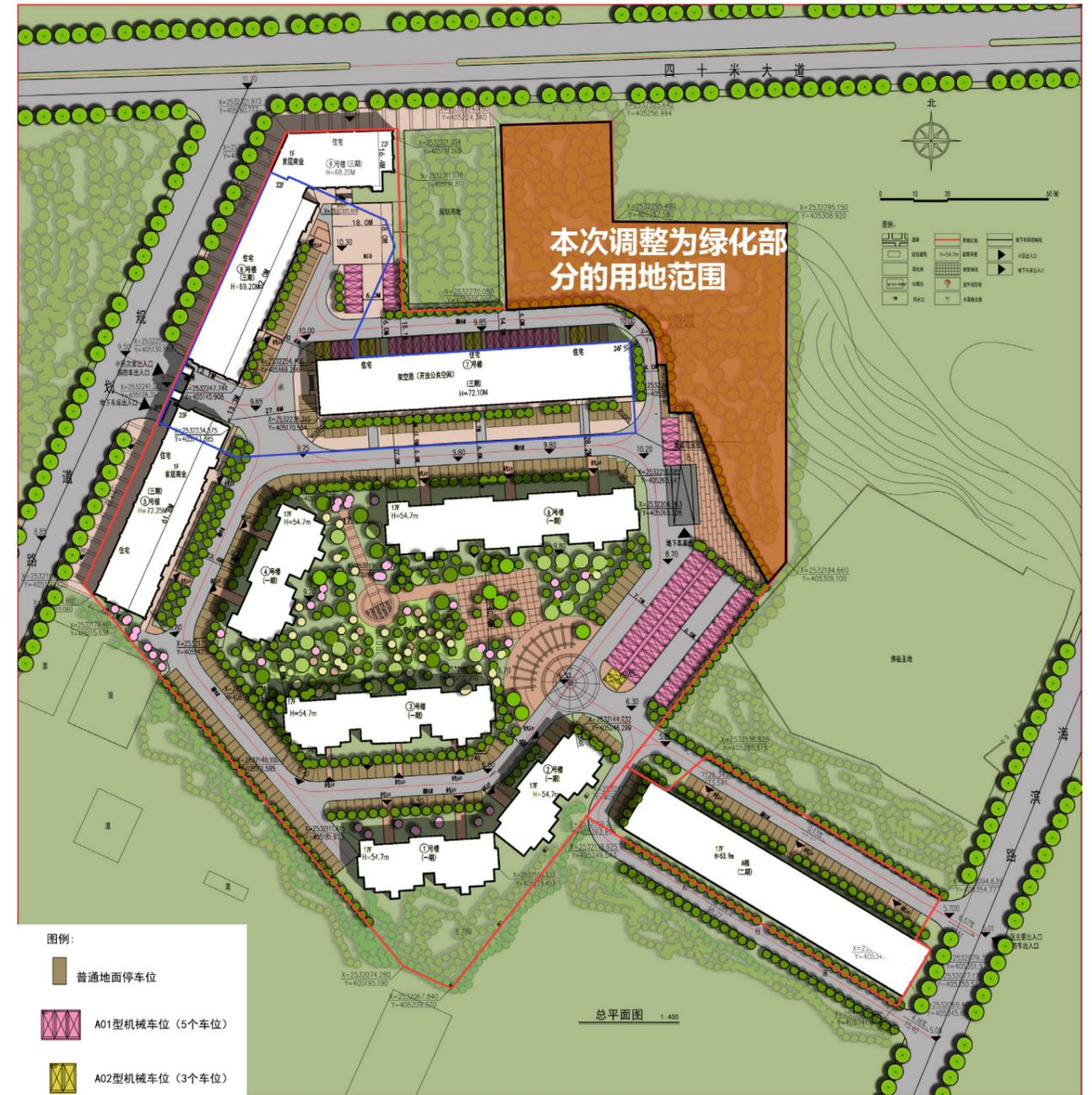
如图所示，由于项目东北角地块被占据使用，在原有规划方案除停车位外其余部分不做调整的基础上增加机械停车位，以满足规划设计要求。
