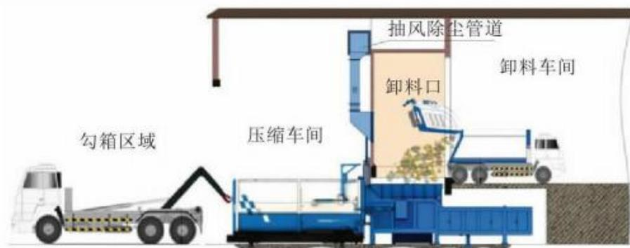
图 2-5 水平压缩转运站的示意图
