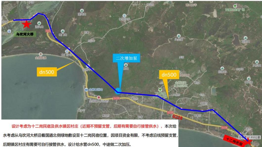
图 6.4-1 扩网工程管网延伸总布置图
