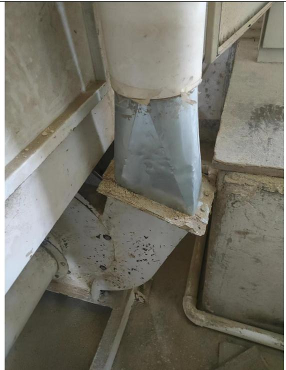
辊米机吸尘点示例
